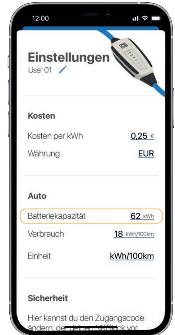
**6.2.** Unter „Batteriekapazität“ können Sie die Batterie-Größe hinterlegen. Schieben Sie den Einstellungsbereich nach unten, um die Änderung zu speichern.
