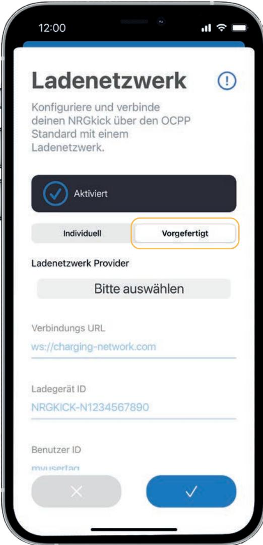
**9.2.** Sofern der Ladenetzwerk-Partner fest eingebunden ist, wählen Sie „Vorgefertigt“ aus. Verbindungs-URL und Ladegerät-ID werden in diesem Fall vorausgefüllt (aus Bestandteilen der NRGkick-Seriennummer).
