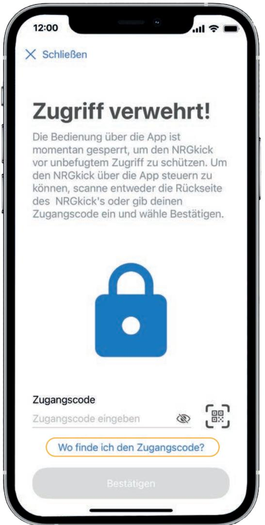
2.2. Eingabe des Zugangscodes: Der Zugangscode setzt sich aus den 7 Stellen vor dem Buchstaben „S“ in der Seriennummer zusammen. Die Seriennummer finden Sie auf der Rückseite des NRGkick. Alternativ kann der QR-Code gescannt werden.
