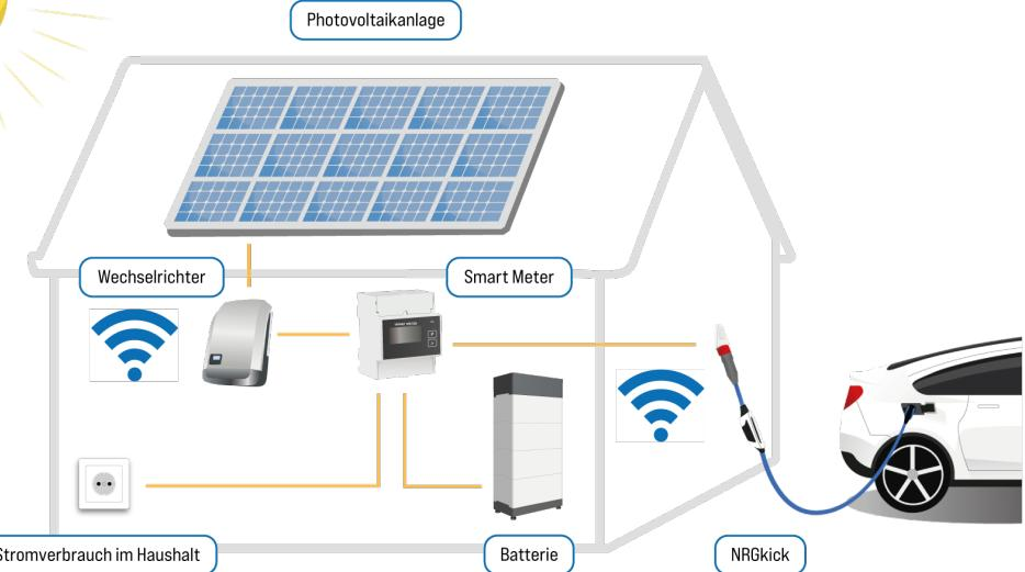
Anschließend bezieht der Haushalt die benötigte Energie aus der PV-Anlage beispielsweise für Lampen, Kühlschränke usw.
